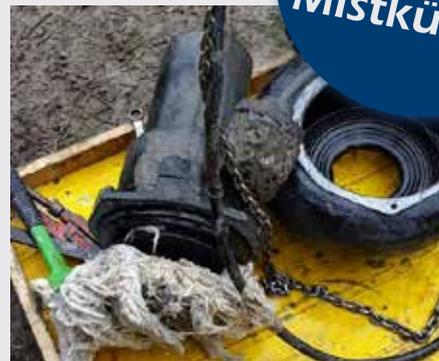
Diese verstopfte Kanalpumpe musste in Gollarn von den Mitarbeitern des GAV ausgebaut und instandgesetzt werden.
